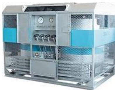
Газификаторы ТГХК-0,75-0,05/1,2 и ТГХК-1,0-0,06/1,6 мобильные предназначены для транспортирования, хранения и газификации сжиженных кислорода, азота, аргона и выдачи их потребителю в газообразном состоянии.
