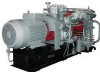
Компрессорный агрегат АВШ-2,5/400 предназначен для сжатия воздуха до давления 40 МПа (400кгс/см<sup>2</sup>).
